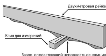
Рис. 1. Измерение неровности основания
